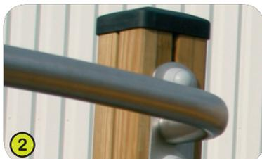
2- **I montanti a sezione quadrata da 95 x 95 mm** sono in pino lamellare incollato trattato in autoclave senza cromo né arsenico. Ciò previene il legno dall'attacco di funghi e insetti. Senza schegge, con scanalature verticali sui quattro lati, il lamellare incollato garantisce grande solidità e stabilità dimensionale.
