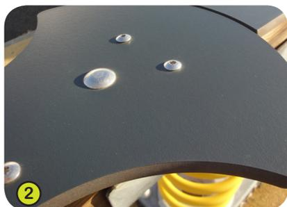
2- **Les sièges** sont élaborés à partir d'un matériau compact d'une épaisseur de 13 mm. Composé de 70% de fibre de bois tendre et de 30% de résine thermodurcissable, celui-ci présente une excellente résistance aux intempéries.
