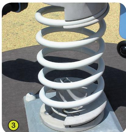
3- **Le ressort** est en acier 35SCD6. Sa surface est traitée après grenailage de précontrainte puis recouverte de l'apprêt zinc et de 2 couches de poudre époxy polyester de 100 microns. La pièce de maintien (Brevet Proludic), en polyamide chargé, assure une longévité et une sécurité exceptionnelle au système.
