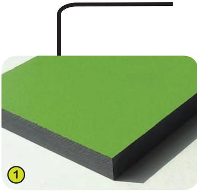
1- **Les plaques colorées** sont élaborées à partir d'un matériau compact d'une épaisseur de 13 mm. Composé de 70% de fibre de bois tendre et de 30% de résine thermodurcissable, celui-ci présente une excellente résistance aux intempéries. Les faces colorées sont traitées à base de résines acryliques polyuréthanes pigmentées, ce qui assure une bonne tenue aux ultraviolets et aux dégradations.
