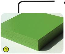
1- Les plaques laquées sont élaborées à partir d'un contreplaqué de 22 mm de très haute qualité composé de plis minces en bouleau. La mise en couleurs, réalisée par pulvérisation électrostratique de laque polyuréthane bicomposant exempte de métaux lourds, assure une haute capacité de résistance aux agresseurs chimiques potentiels comme, par exemple, les produits d'entretien anti-graffiti.
