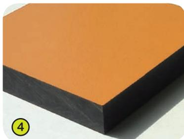
4- **La signalétique** est élaborée à partir d'un matériau compact d'une épaisseur de 13 mm. Composé de 70% de fibre de bois tendre et de 30% de résine thermodurcissable, celui-ci présente une excellente résistance aux intempéries. Les faces colorées sont traitées à base de résines acryliques polyuréthanes pigmentées, ce qui assure une bonne tenue aux ultraviolets et aux dégradations.
