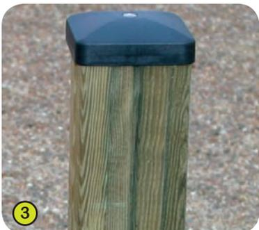
3- **Les poteaux de la signalétique** sont en pin lamellé-collé traité sans chrome ni arsenic. Exempt d'échardes, le lamellé-collé assure une grande solidité et une stabilité dimensionnelle. Les poteaux sont protégés contre les attaques de champignons, d'insectes et de termites. Ils sont recouverts d'un chapeau en polyamide chargé qui est riveté sur le poteau.
