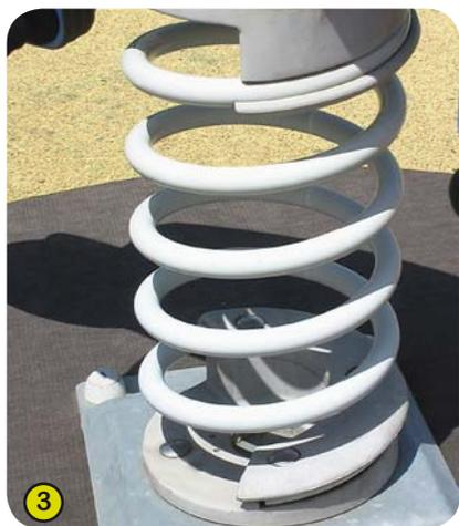
3- **Die Federn** sind aus Stahl 35 SCD 6. Die Oberflächen sind nach dem Sandstrahlen vorgespannt und mit einer Zinkgrundierung sowie zwei Schichten Epoxidharzpulver von 100 Mikron versehen. Die Halterung (Proludic-Patent) ist aus Polyamid. Dadurch ist das System langlebig und außergewöhnlich sicher.
