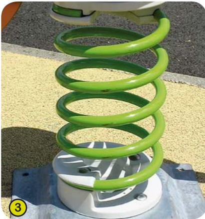
3- **Die Federn** sind aus Stahl 35 SCD 6. Die Oberflächen sind nach dem Sandstrahlen vorgespannt und mit einer Zinkgrundierung sowie zwei Schichten Epoxidharz-pulver von 100 Mikron versehen. Die Halterung (Proludic-Patent) ist aus Polyamid. Dadurch ist das System langlebig und außergewöhnlich sicher.
