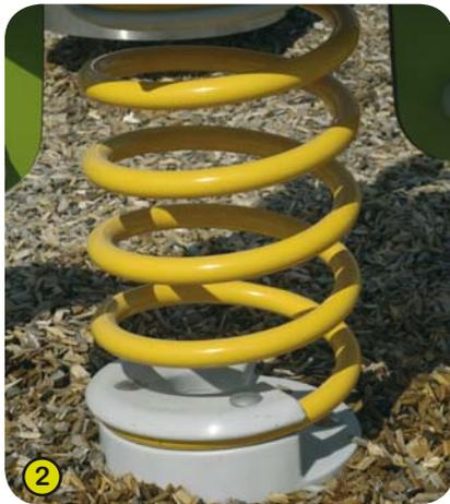
2- **Die Federn** sind aus Stahl 35 SCD 6. Die Oberflächen sind nach dem Sandstrahlen vorgespannt und mit einer Zinkgrundierung sowie zwei Schichten Epoxidharz-pulver von 100 Mikron versehen. Die Halterung (Proludic-Patent) ist aus Polyamid. Dadurch ist das System langlebig und außergewöhnlich sicher.
