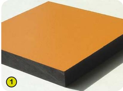
1- **Die farbigen Platten und die Sitze** bestehen aus Trespa-Harzkompositplatten, 13 mm stark (HPL). Temperatur- und witterungsbeständig, widerstandsfähig gegen Vandalismus.
