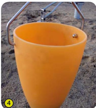
4- **Die Sandeimer** sind im Rotationsguss aus Polyethylen hergestellt.
