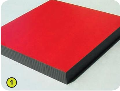
1- **Die farbigen Platten** bestehen aus Trespa-Harzkompositplatten, 13 mm stark (HPL). Temperatur- und witterungsbeständig, widerstandsfähig gegen Vandalismus.
