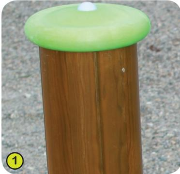
1- **Die 125 mm dicken Rundpfosten** sind aus chrom- und arsenfrei kesseldruckimprägniertem Kieferleimbinder. Das Leimholz ist splitterfrei, sehr solid und formbeständig. Die Pfosten sind gegen Pilz-, Insekten- und Termitenbefall geschützt. Schutzkappen aus Polyamid an den Pfahlspitzen verhindern das Eintreten von Regenwasser.
