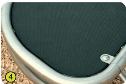
4- Die **„Durax“ Stand- und Trittflächen** sind aus 22 mm dicken, alternierend verleimten Birkenholzpaneelen. Die Oberflächen sind mit rutschhemmendem, thermoplastischem Polyolefin beschichtet und mit Edelstahl-Rohr mit 40 mm Durchmesser eingefasst.
