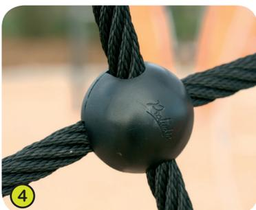
4- **Die Seile und Kletternetze** sind aus mit Polyester ummanteltem, verzinktem Stahldrahtseil. Die Knotenpunkte aus Polyamidspritzguss verbinden die Seile und sorgen für festen Halt.
