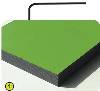
1- **Les plaques colorées** sont élaborées à partir d'un matériau compact d'une épaisseur de 13 mm. Composé de 70 % de fibres de bois tendre et de 30 % de résine thermodurcissable, celui-ci présente une excellente résistance aux intempéries (soleil, pluie, humidité...). Les faces colorées sont traitées à base de résines acryliques polyuréthanes pigmentées, ce qui lui assure une bonne tenue aux UV et aux dégradations.
