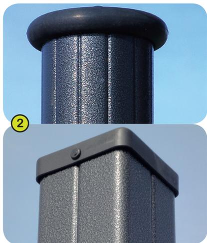
2- **Les poteaux**, diamètre 125 mm, et **les poteaux centraux**, 95 x 95 mm, sont en acier galvanisé laqué. La finition granitée en deux tons de gris présente de légers reliefs et confère une meilleure résistance aux rayures. Les poteaux ronds sont recouverts d'un chapeau en polyamide injecté. Les poteaux carrés sont recouverts d'un chapeau en polyamide chargé.
