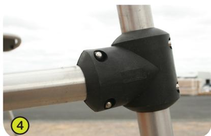
4- **Les tubes** sont en acier inox Ø 40 mm garantissant la longévité et l'esthétique du jeu au fil des années. **Les pièces de jonction** sont moulées en polyamide chargé. Elles sont non toxiques et ininflammables. Résistantes aux chocs et aux ultraviolets, elles assurent la robustesse du jeu et une résistance au vandalisme.
